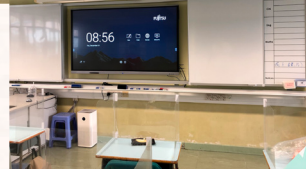
▲ 電子白板採取嵌入式設計，白板完全平滑成裝置於手寫白板內
